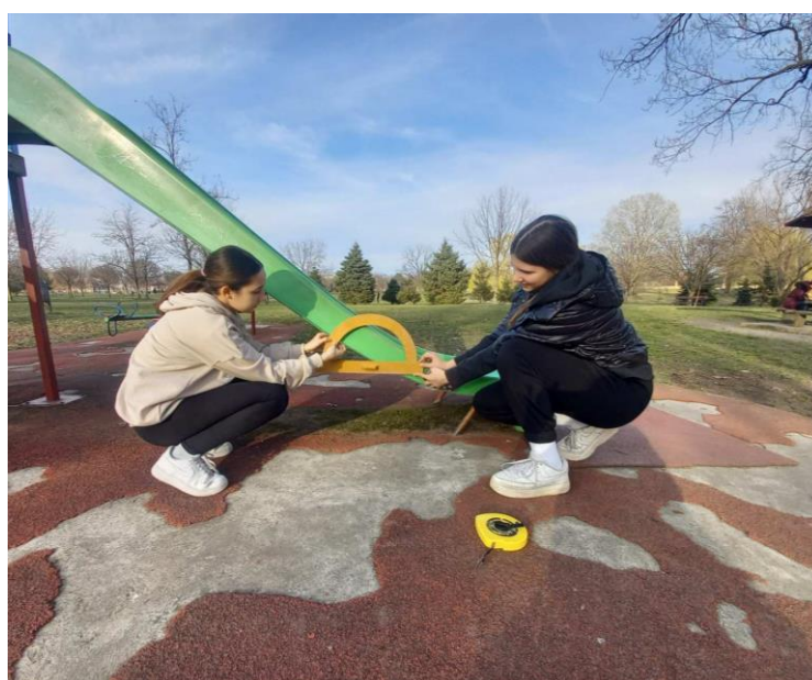
Сл. 13.ц Мерење угла нагиба тобогана
