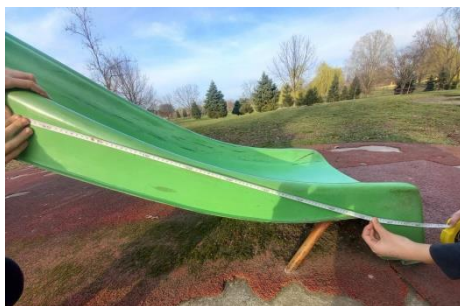
Сл. 9 Мерење дужине тобогана
